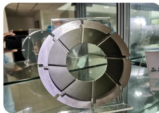
▲ 高精度空气悬浮轴承箔片
